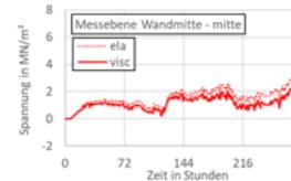
Abbildung 2.4.4: Dehnungs- und Spannungsentwicklungen Langzeitmonitoring Koralmbahn Baulos 3.1
